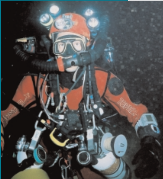
Photographie 1 : Redondance asymétrique, la Mescla (06). Circuit fermé KISS + Circuit ouvert secours.
